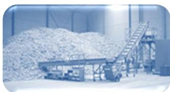
L'usine dispose d'une capacité de traitement d'environ 11 000 tonnes par an. Elle intègre une chaîne de broyage, des microniseurs, des silos et des espaces de stockage.
